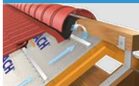
Dettaglio ventilazione colmo
