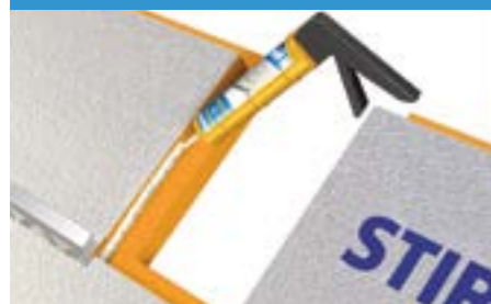
Dettaglio sigillatura dei giunti
