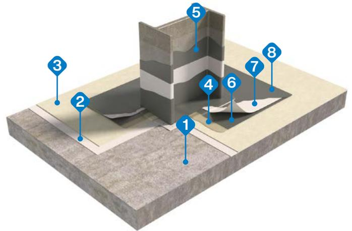
In alternativa si può utilizzare **ALSAN FLEECE 225GF** (in sostituzione a **ALSAN FLEECE 165B**) in due strati totali di 2,0 kg/m<sup>2</sup> di **ALSAN FLASHING QUADRO** fresco su fresco.
